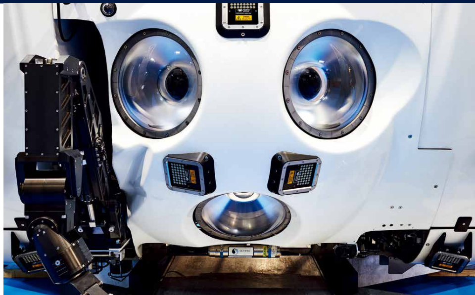
席が2つあり、覗き窓が膝の高さにある。深海におけるかなりの圧力にも対応できるように、覗き窓は内側に可動する設計になっている。胸の高さには、炭素繊維の酸素タンクが10個並んでいて、最悪の事態に備え、2人×4日分の酸素が蓄えられている。
